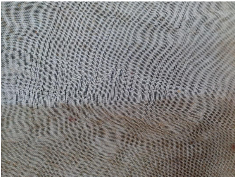
Figur 2: 10-metring med skader etter vaske ved 220 bar.
