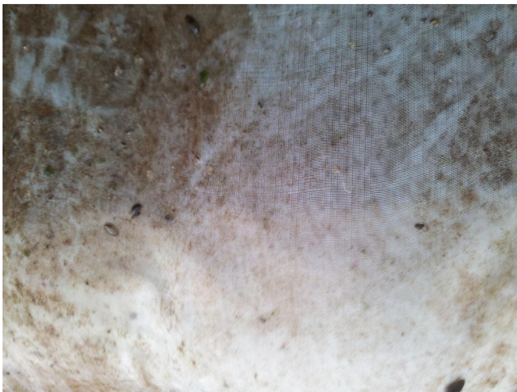
Figur 3: 10-metring vasket ved 100 bar med antydning til skade og ikke tilfredsstillende rengjøring.
